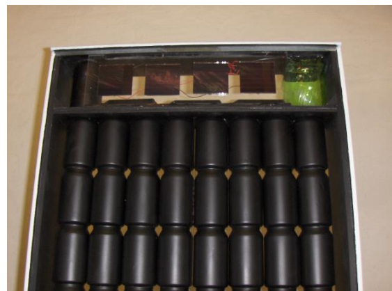
Nu er det lige før at akrylpladen skrues fast.
