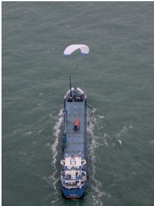
Figur 3: Skysails dragesejl demonstreret på fragtbåd, Copyright: Skysails, http://www.skysails.info . Dette sejl giver dog kun et minde bidrag til fremdriften.
